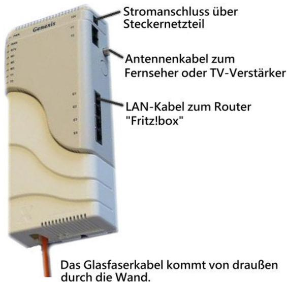
Grundsätzlich gilt, dass das „SWN-Netzabschlussgerät“ an der Innenseite der Außenmauer angebracht wird. Für sein Steckernetzteil benötigt es eine 230 Volt Steckdose.
